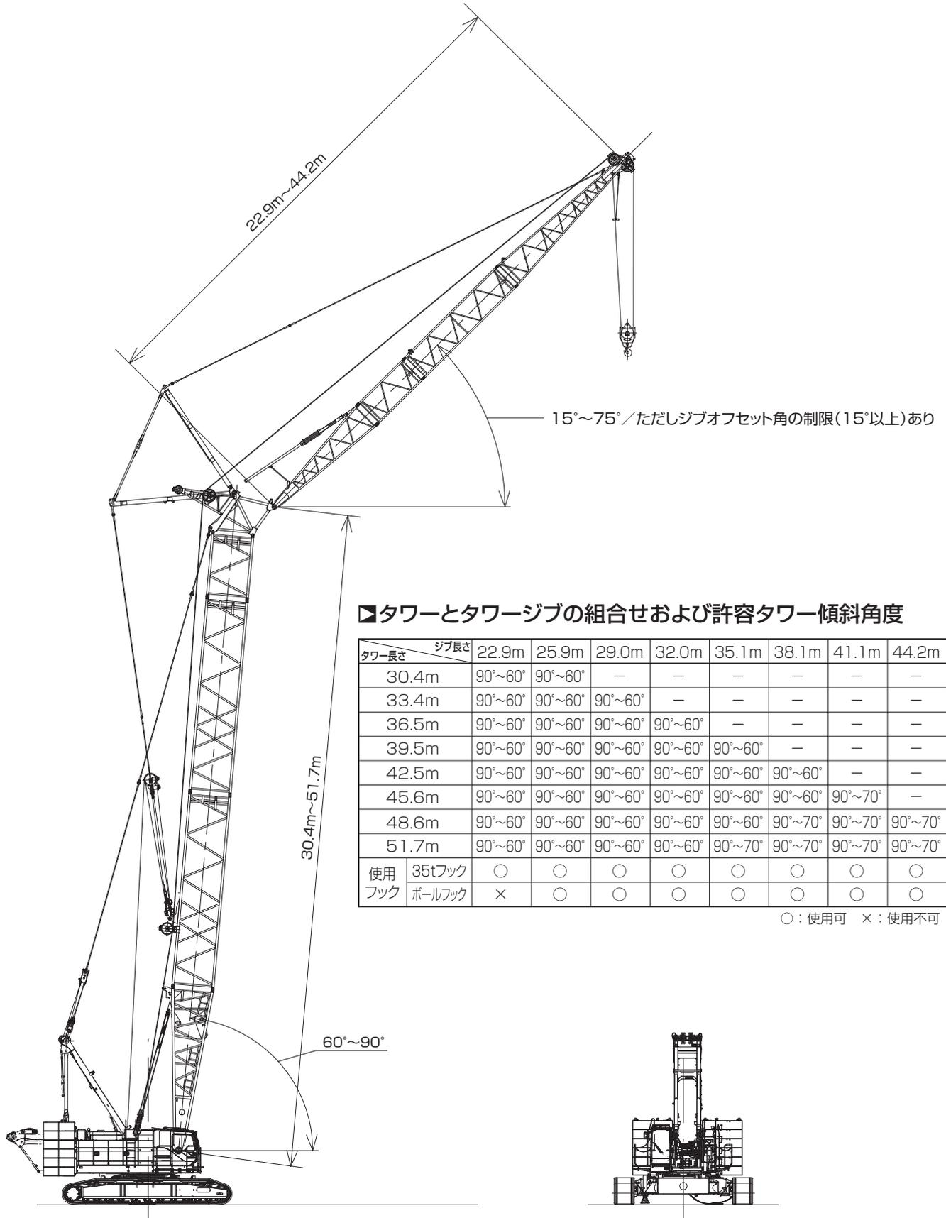
▶タワーとタワージブの組合せおよび許容タワー傾斜角度
